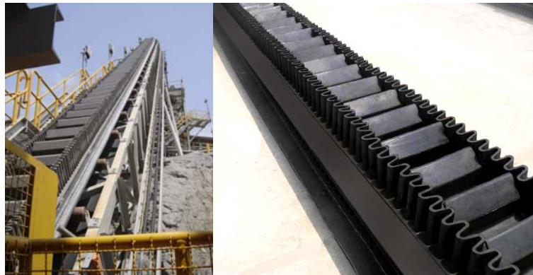
Sidewall Belt ของ Phubia Mining ลำเลียง Gold Ore Bw 1,000 mm Capacity 700 TPH
