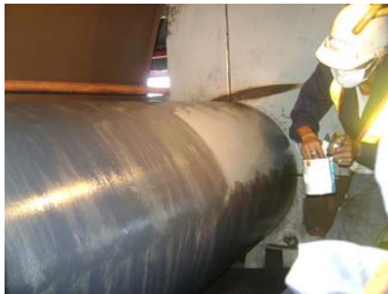
ทากาว Cement SC 2000 ที่ยางหุ้มและผิว Pulley อย่างละ 2 รอบ
