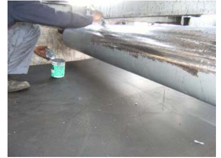
ทากาว Cement SC 2000 นำแผ่นยางมาหุ้ม Pulley และใช้ฉ้อนยางทูปไล่อากาศให้ทั่ว ขัดแต่งรอยต่อของยางให้เรียบร้อย
