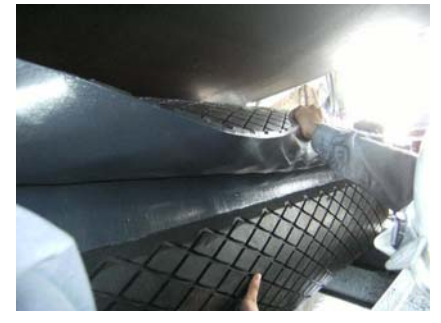
นำแผ่นยางมาหุ้ม Pulley และใช้ฉนวนยางทาบไล่อากาศให้ทั่ว ขัดแต่งรอยต่อของยางให้เรียบร้อย
