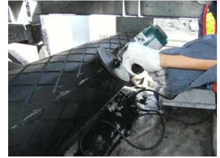
นำแผ่นยางมาหุ้ม Pulley และใช้หมอนยางทาบ ไล่อากาศให้ทั่ว ชัดแต่งรอยต่อของยางให้ เรียบร้อย
