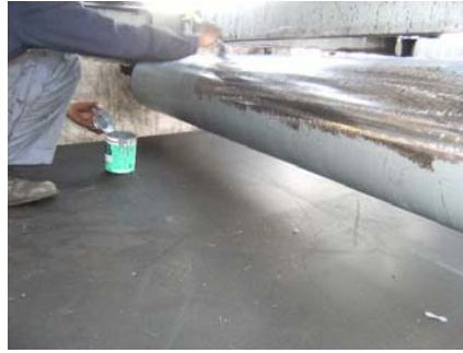
ทา Metal Primer PR 200 และทากาว Cement SC 2000 ที่ยางหุ้มและผิว Pulley อย่างละ 2 รอบ
