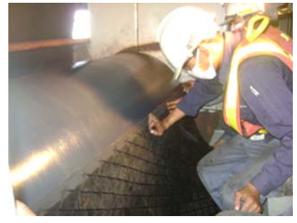
นำแผ่นยางมาหุ้ม Pulley และใช้ฉนวนยางทาบไล่อากาศให้ทั่ว ชัดแต่งรอยต่อของยางให้เรียบร้อย
