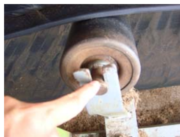
สภาพลูกกลิ้งเหล็กใช้งาน 6 เดือนใกล้ซายทะเลก็เป็นสนิมแล้ว
