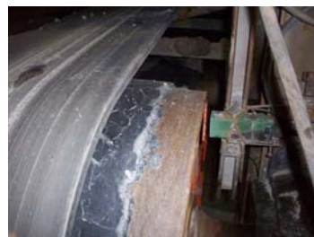
Skirt ที่ติดตั้งไม่ดีทำให้ชูดสายพาน เป็นรอยยาวตลอดแนว
