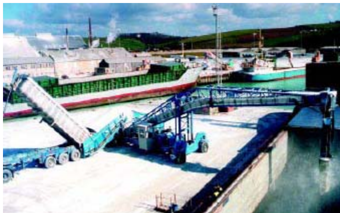
ตัวอย่างภาพ Ship loader ขณะทำงาน
